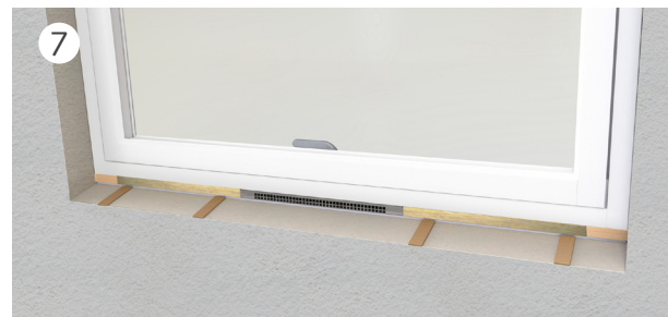
7 Fönsterblecket monteras så att uteluft kan strömma in och ledas vidare i kanalen. Vid behov kompletteras monteret med distanser och/eller fästbleck
